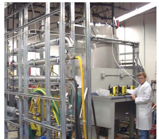
BAC-9™ 4000-L 醗酵槽と細胞濃縮器
